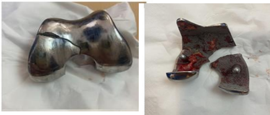
Figura 2. Rotura de cóndilo medial del escudo femoral de prótesis de rodilla
